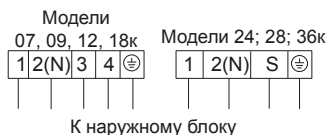
Терминал для подключения проводов на внутреннем блоке
